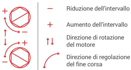
Per impostare la posizione finale superiore o inferiore, avviare l'avvolgibile nella direzione di apertura o di chiusura, finché la tapparella non si fermerà nella posizione preimpostata. Per aumentare l'intervallo, ruotare la manopola in direzione "+". In presenza di un intervallo eccessivo, ridurlo effettuando una rotazione in direzione "-".
