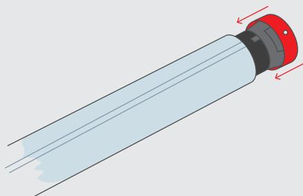
5. Inserire il dispositivo di movimentazione nel tubo di avvolgimento, in modo tale che il bordo del tubo aderisca al bordo interno della testata.
