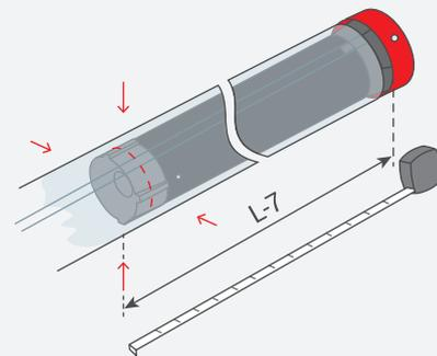
6. Fissare il tubo di avvolgimento all'involucro, utilizzando quattro viti o rivetti, collocati a una distanza L-7 mm dal bordo interno della testata.
