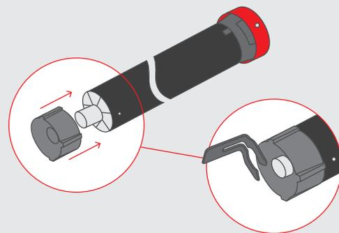
3. Montare l'adattatore sul dispositivo di movimentazione.
