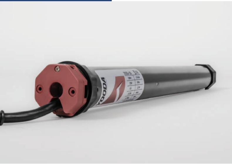
I dispositivi di tipo S sono dispositivi di movimentazione standard, utilizzati per rendere automatico il funzionamento degli avvolgibili interni, delle tapparelle esterne e delle porte carrabili avvolgibili. Possono essere comandati con un interruttore a pulsante o con un ricevitore radio esterno. Sono provvisti di interruttori di fine corsa meccanici che permettono di fermare il motore al raggiungimento della posizione stabilita da parte dell'avvolgibile.
