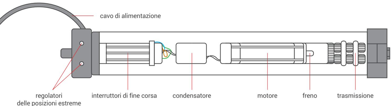
Il tempo di funzionamento massimo del dispositivo è pari a circa 4 minuti. Al superamento di questo periodo, entrerà in funzione il meccanismo di sicurezza termico, che disattiverà il motore per proteggerlo dal surriscaldamento. Dopo che l'interruttore termico sarà entrato in funzione, attendere 20 minuti, affinché il dispositivo possa essere riutilizzato.
