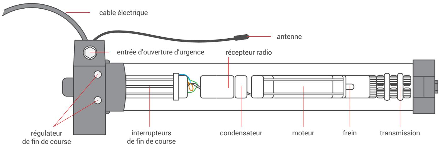
La durée maximale de fonctionnement du moteur est d'environ 4 minutes. Passé ce délai s'actionne une protection thermique qui déconnecte l'entraînement protégeant le moteur de toute surchauffe. Après l'activation de l'interrupteur thermique, il faut attendre environ 20 minutes pour que le moteur revienne à un mode normal de fonctionnement.
