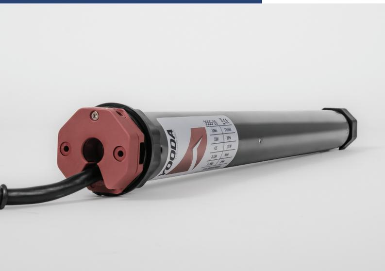
Les moteurs de type S sont des moteurs standard destinés à l'automatisation du fonctionnement des volets intérieurs, des volets extérieurs et des portes roulants. Ils peuvent être commandés à l'aide d'un interrupteur ou d'un récepteur radio externe. Ils disposent d'interrupteurs de fin de course mécaniques qui permettent d'arrêter le moteur lorsque le volet est dans une position définie.
