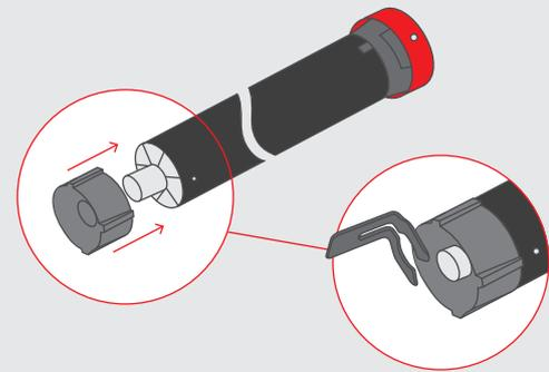
3. Montare l'adattatore sul dispositivo di movimentazione.
