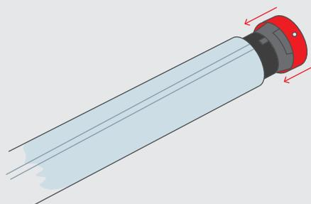
5. Inserire il dispositivo di movimentazione, in modo tale che il bordo del tubo aderisca al bordo interno della testata.
